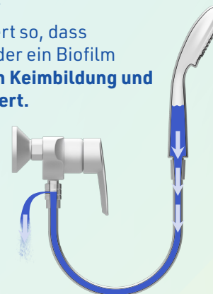
Automatische Entleerung des Duschkopfs (Legio-Variante)
