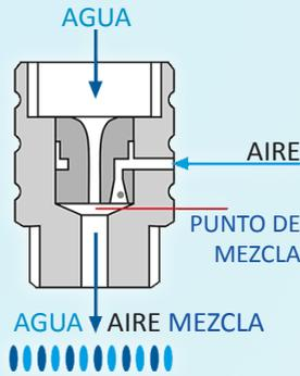
En comparación con otros limitadores de flujo convencionales, el ecoturbino® logra mantener la forma del chorro y por lo tanto sin cambios en la comodidad de la ducha.
